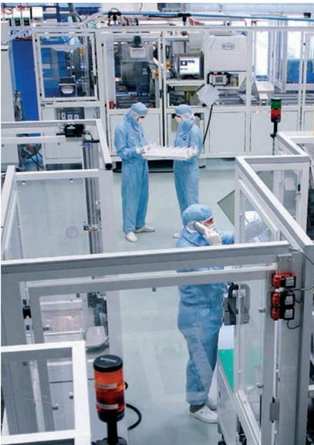
RIWISA AG entwickelt und fertigt vom klassischen Formteil bis zur komplexen Baugruppe für den internationalen Markt. In den total 7'000 m<sup>2</sup> Produktionsflächen, wovon 3'800 m<sup>2</sup> Reinraum der Klasse C, garantieren neueste Technologien für sichere Fertigungsprozesse in der geforderten Qualität.
