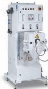
RSC Bepuderungsanlagen für Schläuche, Profile, Bänder, Kabel, Drähte
