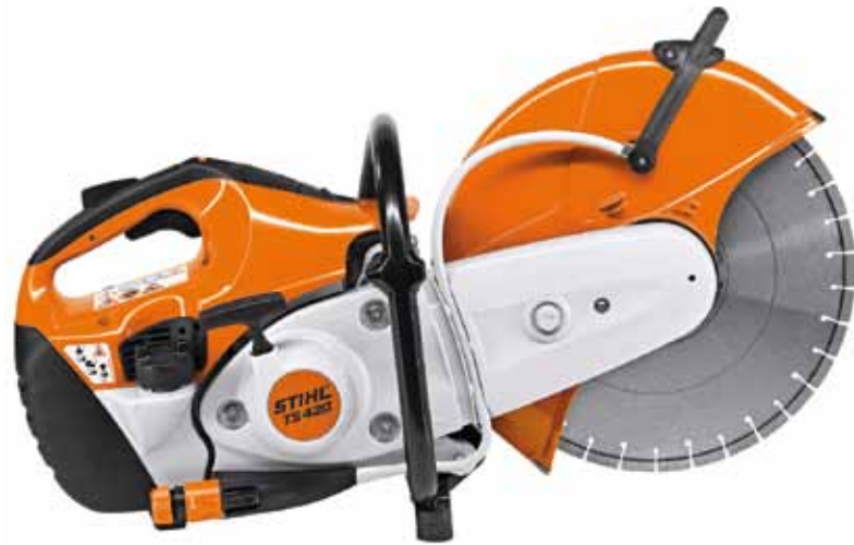
Bild. Die Schutzabdeckung dieses Trennschleifers ist aus Magnesium-Druckguss hergestellt und wiegt 690 g. Der Umstieg von der Vorgängerversion aus Aluminiumblech (1.040 g) auf Magnesium erbrachte eine Gewichtsreduktion von 34% und eine Halbierung der Herstellkosten. (Bildquelle: Andreas Stihl AG & Co. KG, Magnesium Druckguss)
