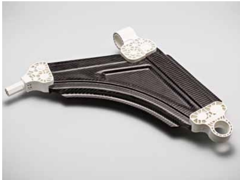
Der Querlenker aus CFK ist bis zu 45 Prozent leichter als ein herkömmliches Bauteil. Sein Zustand wird von einem integrierten Structural-Health-Monitoring-System (SHM) überwacht. Die Fraunhofer-Allianz Leichtbau wird diese Komponente zur Sonderschau „Intelligenter Leichtbau“ im Rahmen der Intec und Z 2017 präsentieren. Foto: Fraunhofer LBF
