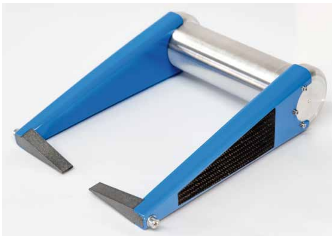
Schnell bewegte, schwingende Metallteile in Maschinen können durch leichtere und dennoch hochfeste Komponenten in Mischbauweise ersetzt werden, wie das Beispiel eines Positionierhebels für Verpackungsmaschinen in CFK-Aluminium-Ausführung zeigt, der von der Leichtbau-Zentrum Sachsen GmbH entwickelt wurde. Foto: LZS GmbH
