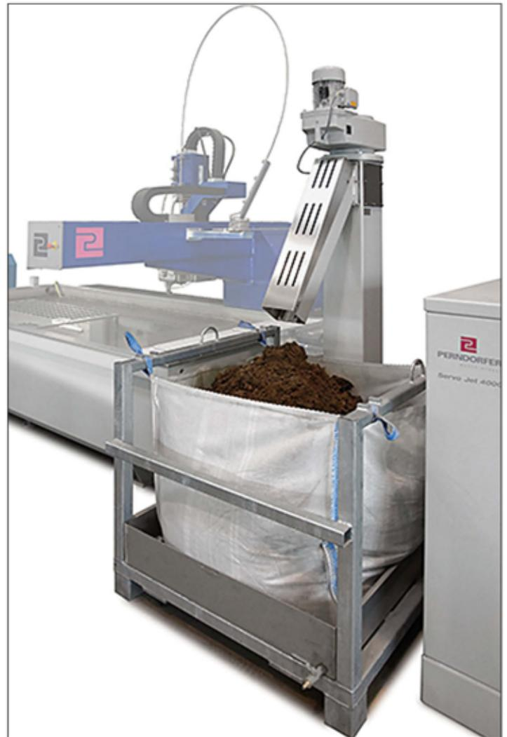
Die Schlammaustragung bei Wasserstrahlschneidanlagen der Perndorfer Maschinenbau KG arbeitet nahezu Verschleißfrei und äußerst wartungsarm. Dies senkt die Betriebskosten und ermöglicht ein wesentlich wirtschaftlicheres Produzieren.
