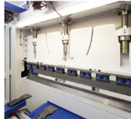
arbeitet simultan als Biegeachse und Bombierachse. Der Biegebalken kann damit CNC-gesteuert deformiert werden. Jede Achse arbeitet unabhängig, kompromisslos entsprechend der Bedürfnisse. Die CoastOne-Bombierung ist einzigartig in der Biegetechnik!
