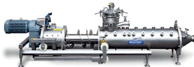
Hygienic Design: Vollständig aus dem Gehäuse ausfahrbares Mischwerkzeug gewährleistet die einfache, gründliche Reinigung, Nassreinigung mittels integrierten Hochdruck-Flachstrahl Düsen
