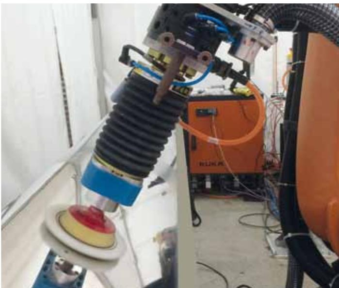
Winkelschleifer mit Kuka-Roboter im Einsatz zum Polieren einer Edelstahlblechtafel
